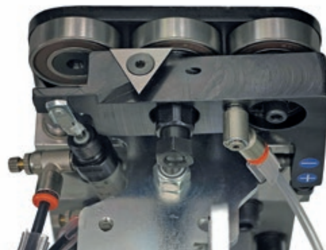
Группа клеевого скребка, которая удаляет избыток клея с верхней и нижней поверхностей панели.
